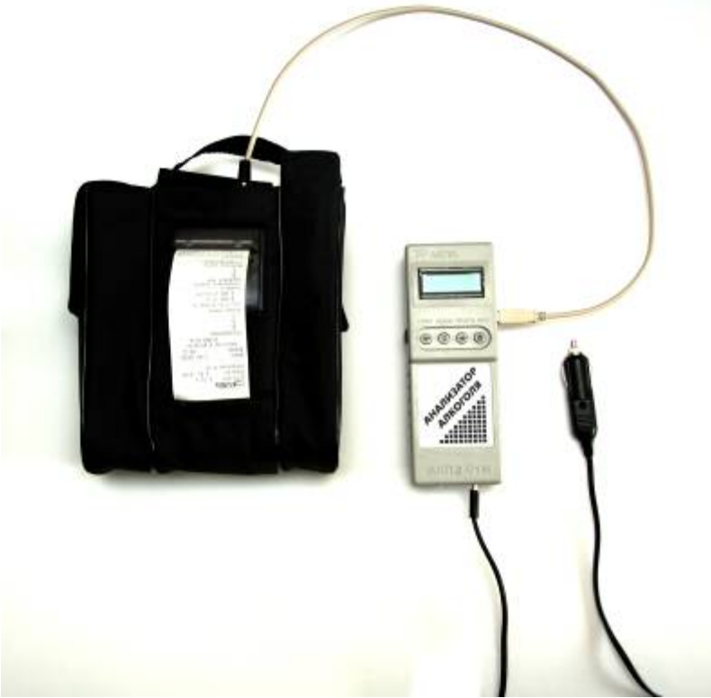
Рисунок 4 – Схема подключения измерительного блока для распечатки протокола измерения при питании от бортовой сети автомобиля через адаптер прикуривателя для прибора при упаковке в футляр (укладочную сумку)
