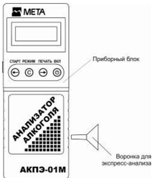
Рисунок 5 – Приборный блок с воронкой для бесконтактного экспресс-анализа
