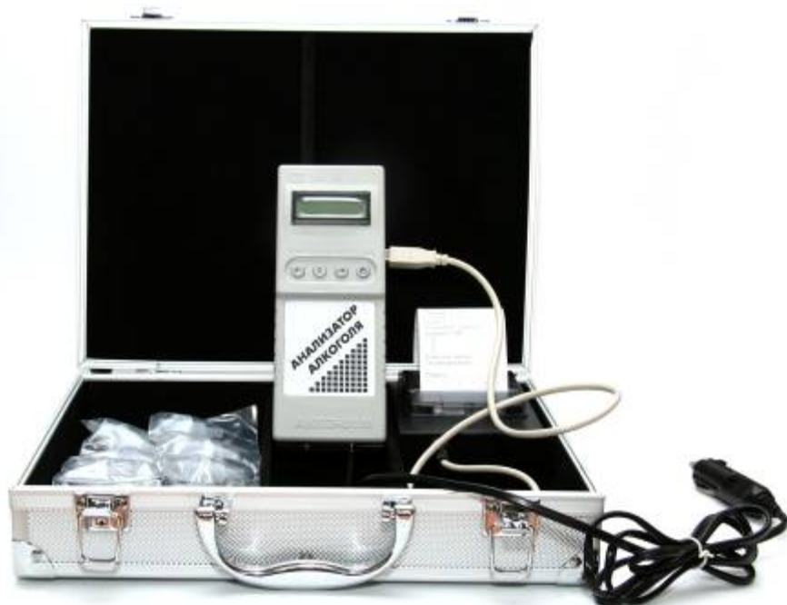
Рисунок 4а – Схема подключения измерительного блока для распечатки протокола измерения при питании от бортовой сети автомобиля через адаптер прикуривателя при упаковке в футляр типа «кейс»
