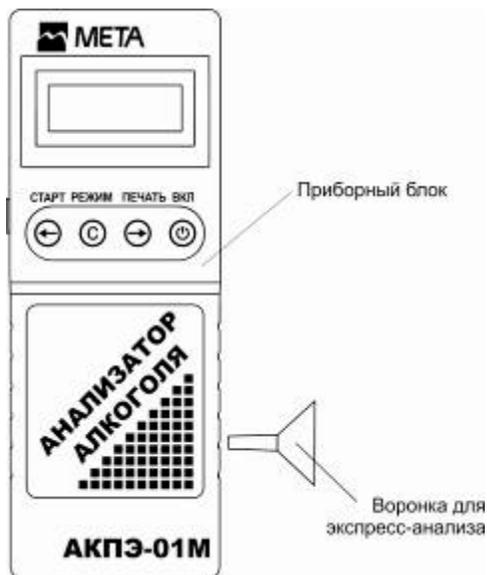
Рисунок 5 – Приборный блок с воронкой для бесконтактного экспресс-анализа
