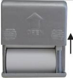
Рисунок 7 – Снятие крышки с приборного блока
