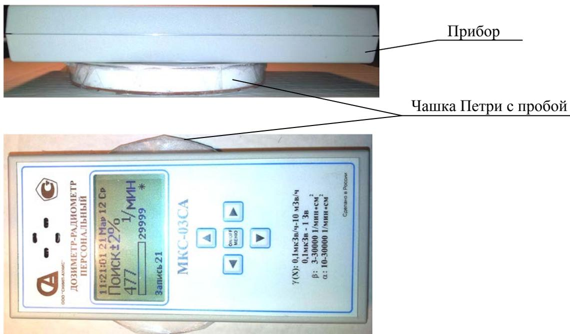
Рисунок 3. Положение прибора и контролируемой пробы во время измерений.
