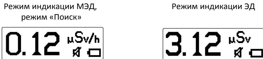
Рисунок 5 - Вид дисплея при измерении в режимах МЭД, «Поиск» и ЭД «кратко»
