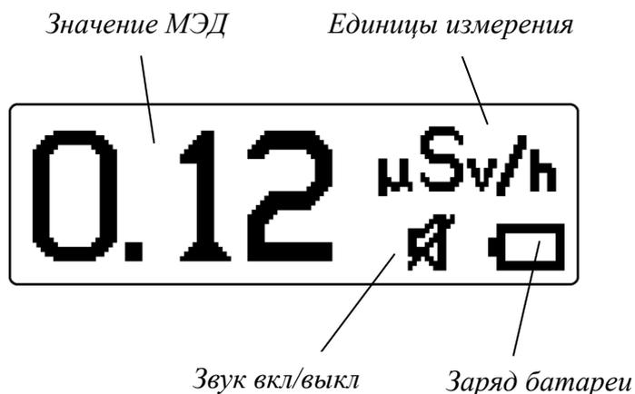
Рисунок 4 – Схема расположения данных на дисплее дозиметра в режиме индикации МЭД, кратко;
