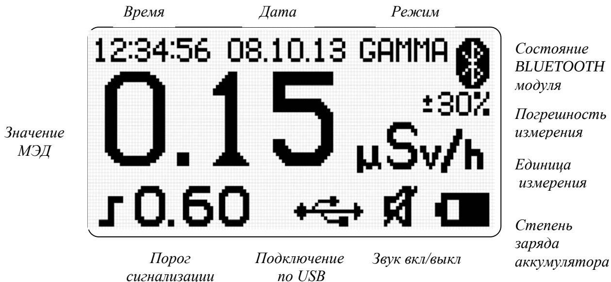
Рисунок 3 – Дисплей дозиметра в режиме МЭД (измерение мощности амбиентного эквивалента дозы фотонного излучения)
