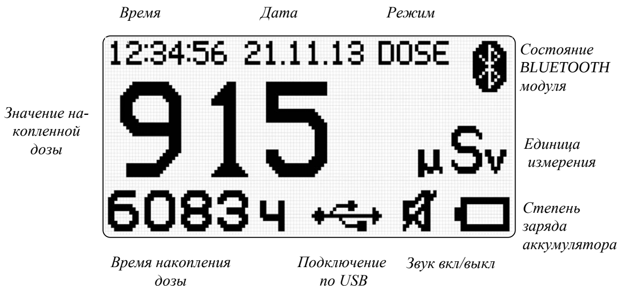
Рисунок 5 - Дисплей дозиметра в режиме индикации ЭД;
