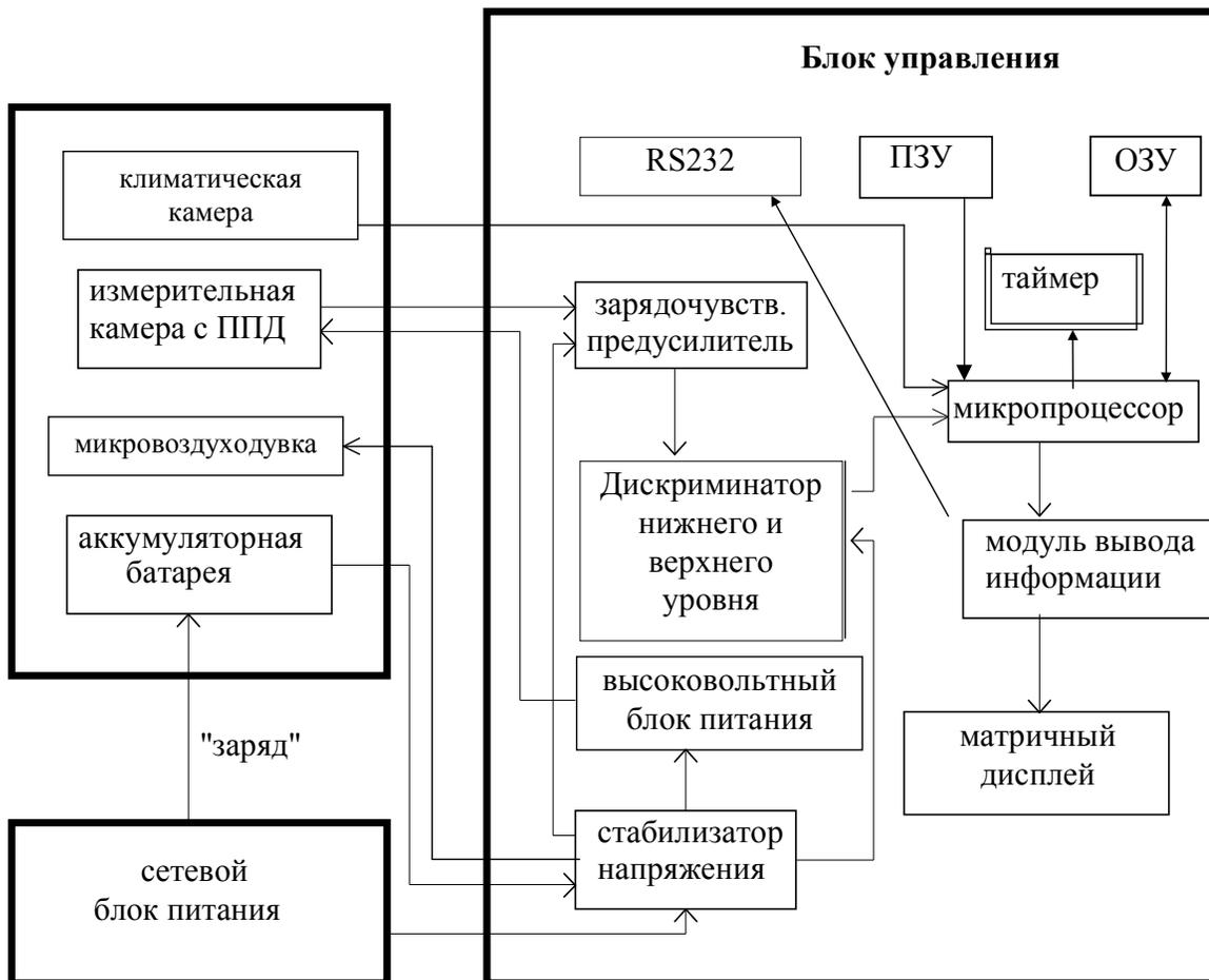
Рис. 2. Функциональная схема радиометра.
