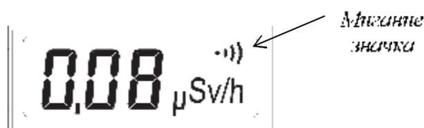
Дозиметр после включения непрерывно измеряет две величины – мощность дозы и полученную дозу (подробнее – см. стр. 7). Измерения обеих величин ведутся одновременно. При включении дозиметр будет отображать показания мощности дозы. Переключение к режиму отображения накопленной дозы и обратно к мощности дозы осуществляется коротким нажатием кнопки **▶** на главном экране прибора.
