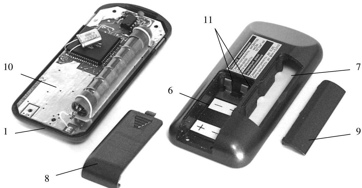
Рисунок 1.2 - Вид сзади со снятой нижней крышкой
